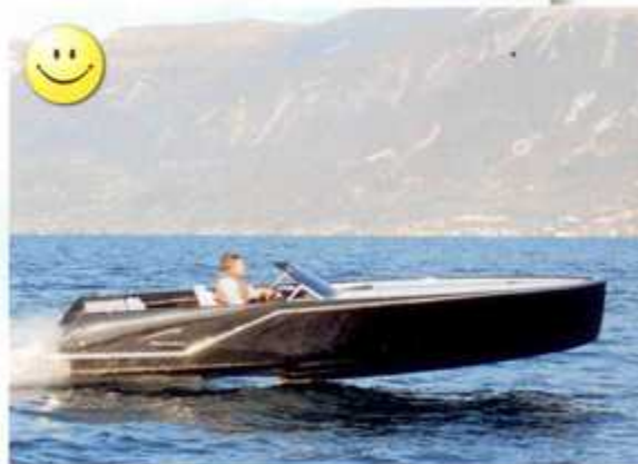
12. Anche con poche onde lo scafo si solleva e rimangono immersi solo l'elica e il timone.
