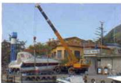
L'autogrù può sollevare fino a un massimo di 25 tonnellate.
